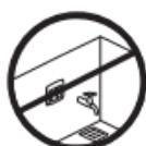
Терморегулятор не можна встановлювати у вологих приміщеннях. В цьому випадку встановлюйте його у суміжній кімнаті. Завжди встановлюйте терморегулятор відповідно до місцевих норм щодо IP класів захисту від вологи.
