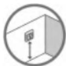
Встановіть терморегулятор на стіні на зручній висоті (зазвичай 80–170 см).
