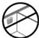
Не встановлюйте терморегулятор на внутрішньому боці зовнішньої стіни.
