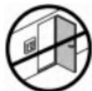
Завжди встановлюйте терморегулятор на відстані щонайменше 50 см від вікон і дверей.
