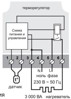
Схема 1. Схема подключения
